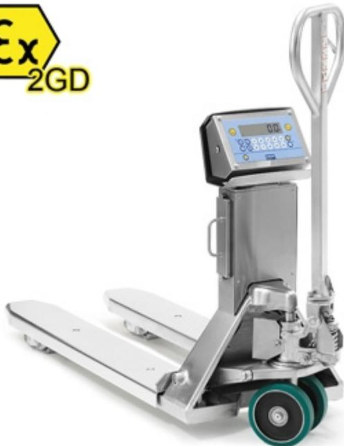
Transpalette peseur ATEX pour usage en zones dangereuses (ZONES 1 & 21 & 2 & 22) avec modes de protection Ex II 2G IIB T4 Gb X et Ex II 2D IIIC T197°C Db X. Structure entièrement en acier INOX. Disponible en version homologuée pour un usage réglementé. Fabriqué, calibré et étalonné en Italie par Dini Argeo, en utilisant des masses étalons certifiées.
