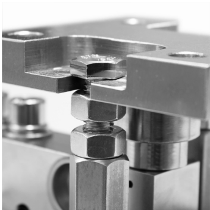
Detail des écrous de bloquage/butée
